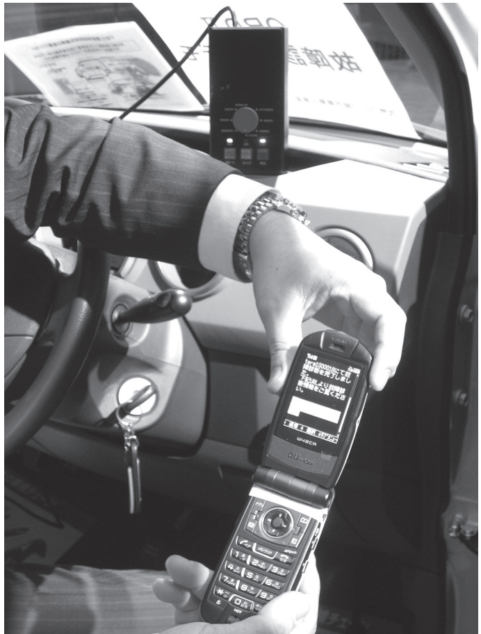
コネクタに接続した故障診断ツール（写真奥）から手前の携帯電話に車両診断情報が送信される。ロータス九州には全国のロータスから説明会などのオファーが殺到している（7月4日・大分市の大分東洋ホテル）
